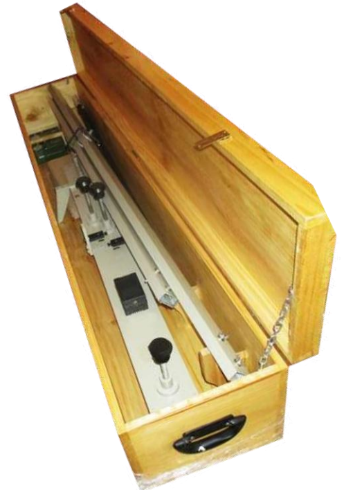
Viga Benkelman (Doble Brazo)
